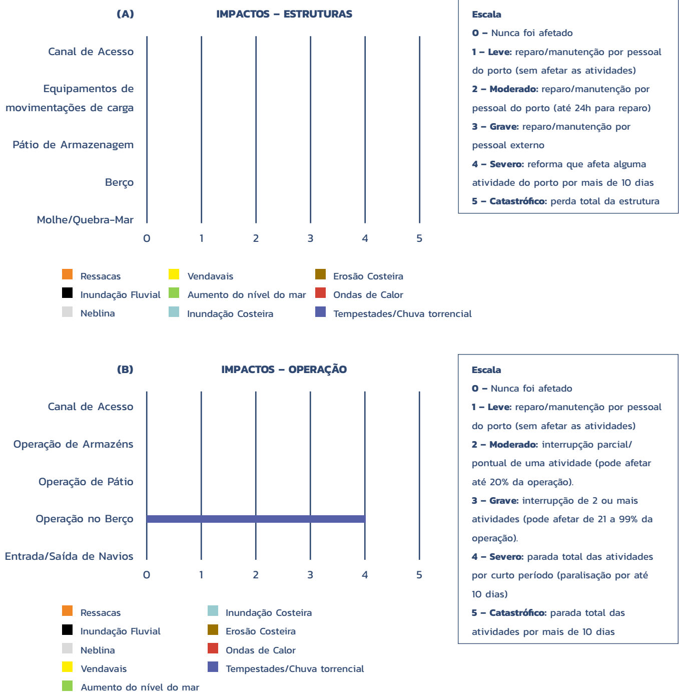
Figura 70: Resultados das questões 11, 17 e 22 do Porto de Vitória: Grau com que cada ameaça climática já afetou negativamente às (a) estruturas (b) operação (c) cadeia logística.
